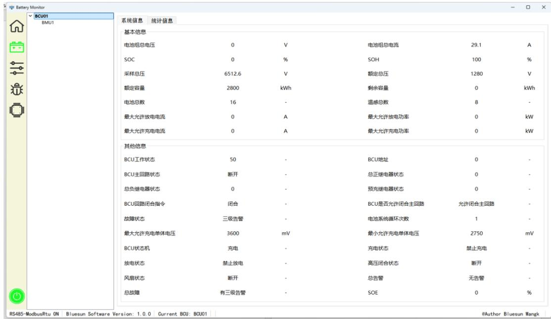
BCU 信息分为系统信息和统计信息两个部分。系统信息包括总电压、总电流、SOC 这样的基本信息和 BCU 工作状态、继电器状态、回路状态这样的状态信息。统计信息包括日充放，累计充放等信息和统计后的最高，最低单体信息等。
